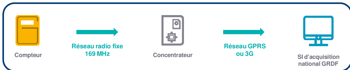
Figure 23 : illustration du fonctionnement du réseau de télé-relève de GRDF
