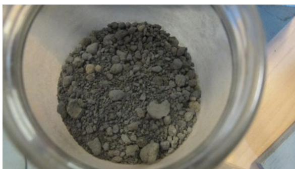
Photo 11 : Boue séchée pulvérulente
